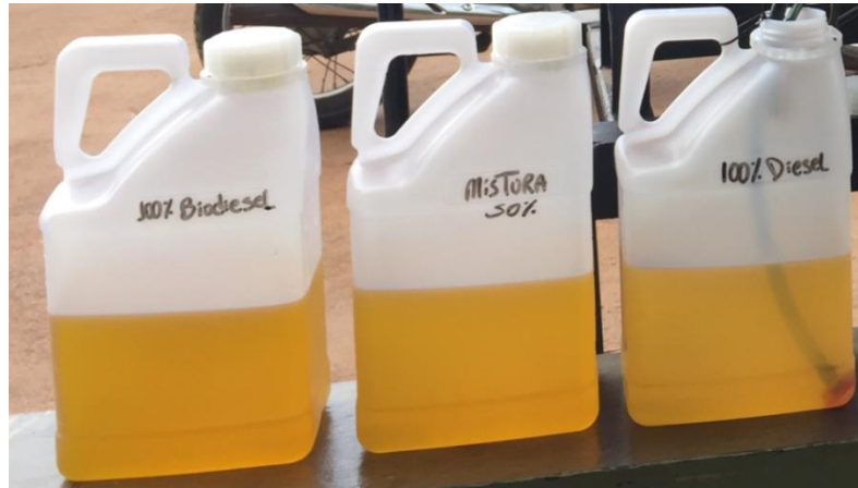
FIGURA 3 - Foto dos recipientes onde foram colocadas as misturas B7, B50 e B100
